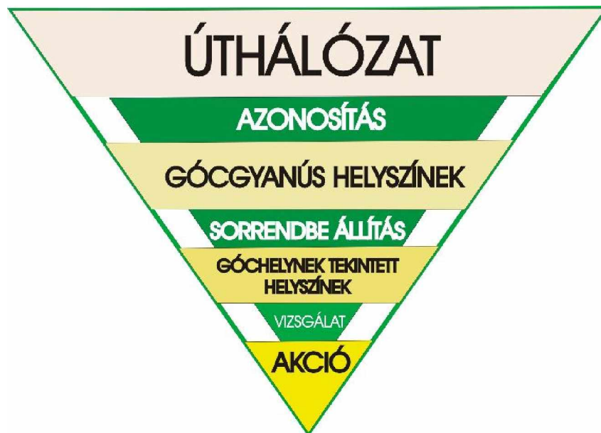
2-2. ábra: A góchelyek feltárásának, vizsgálatának és felszámolásának folyamata
